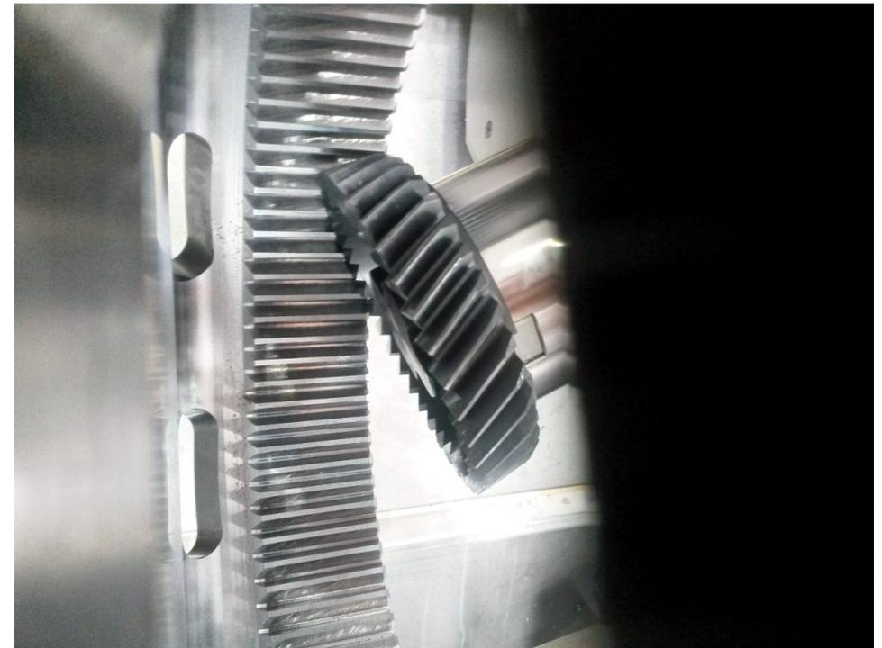
Abbildung 5: Darstellung des Wälzschälprozesses (Fraunhofer IWU)
